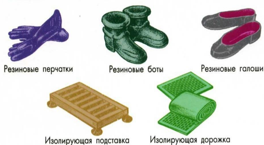
Рис.7. Средства обеспечения безопасности при работе с высоковольтными источниками тока
